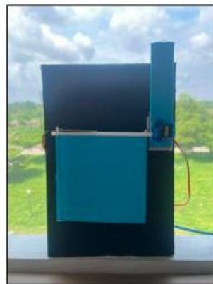
Gambar 4. Kondisi Miniatur Pintu Box Tertutup (Hujan)
